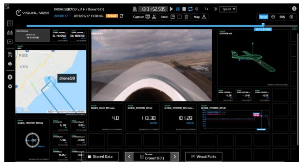
遠隔監視・映像伝送システムの画面
